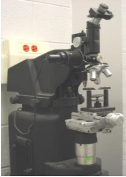
تم تطوير اختبار صلابة فيكرز في عام ١٩٢١ من قبل شركة فيكرز كبديل لطريقة برينل لقياس صلادة المواد وتمتاز بإمكانية إستخدامها لإختبار جميع المواد بغض النظر عن صلابتها، كما تمتاز بالقدره على قياس صلادة العينات الرقيقه أو المصلده غلافيا بعمق قليل. وفى إختبار الصلادة بأسلوب فيكرز يضغط على سطح العينة الإختبارية بالحافة المسلو به لهرم ماسى رباعى الأوجه تبلغ الزاوية بين جوانبه ١٣٦° درجه وتتراوح قيمة الحمل الإختبارى من ١ الى ١٢٠ كيلوجرام
